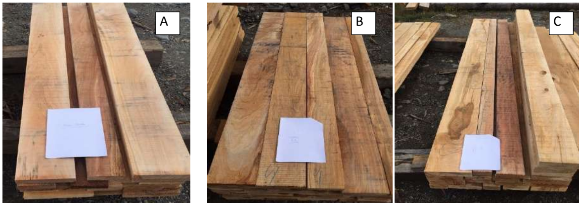
Figura 26. Grados de calidad de madera aserrada; A: Primera-Quinta, B: Sexta y C: Sexta B o L (Fundo Pirihueico, Comuna de Panguipulli)
